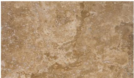
Полу полированная. Поперечная резка, поры заполнены
