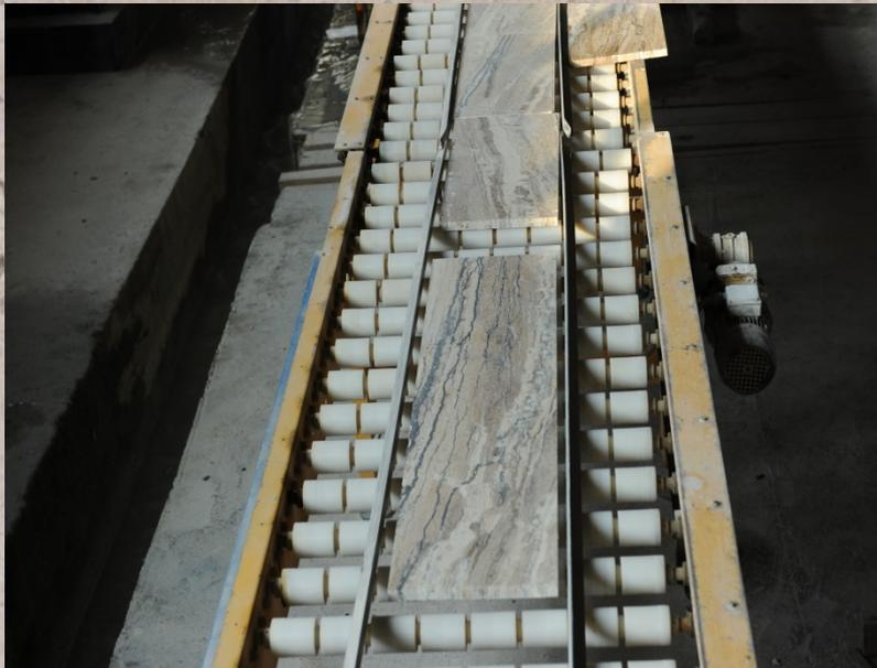
Плиты с замазанными порами высыхают, полируются при помощи станка с десятью полировочными головками. Используя различные сочетания головок получаются фактуры: полированная, полу полированная, состаренная. Обработанный материал далее проходит геометровку. Эта процедура позволяет выдержать правильность углов.
